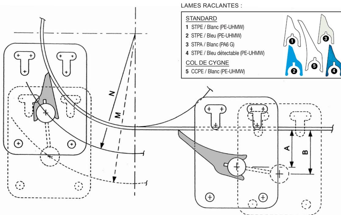
Exemple d'un montage frontal avec lame standard et d'un montage sous-jacent avec lame en col de cygne.
