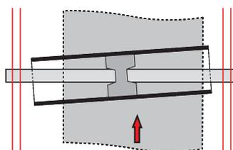
Mouvement de correction du Rollax lors d'un déport à droite de la bande transporteuse.
