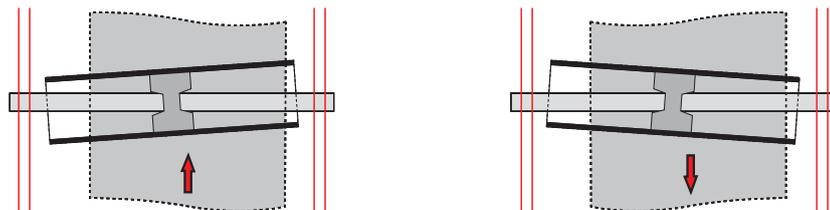
Mouvements de correction du ROLLAX sur un déport du même côté du transporteur selon le sens de marche de la bande.
